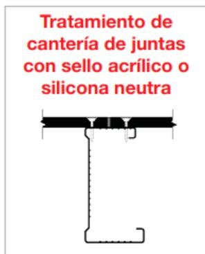
**Para tratamiento de juntas verticales** en estructura de madera o metal se recomienda mantener una separación mínima entre placas de 2 mm. Para luego aplicar el sellador.
